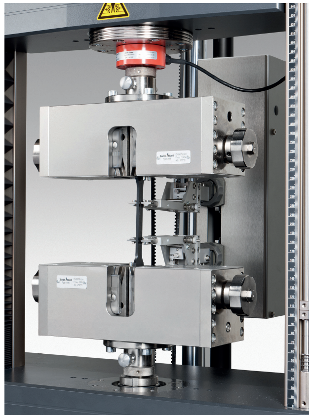
Zugversuche ermöglichen Rückschlüsse auf das Materialverhalten von Kunststoffen. © ZwickRoell
