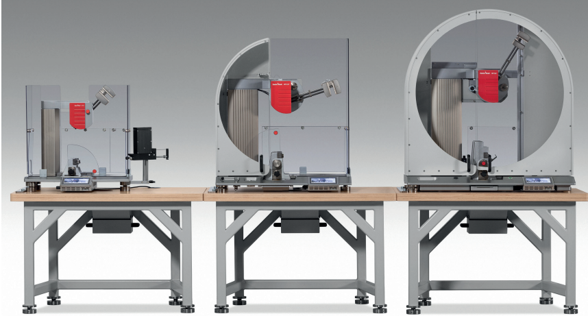
Pendelschlagwerke werden unter anderem verwendet, um die Verformung des Kunststoffs auch bei hohen Geschwindigkeiten zu beurteilen. ©ZwickRoell
